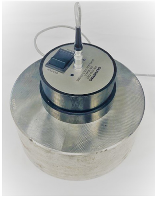
Nastavení snímače pro kontrolu vad ve středu kolejové nápravy
